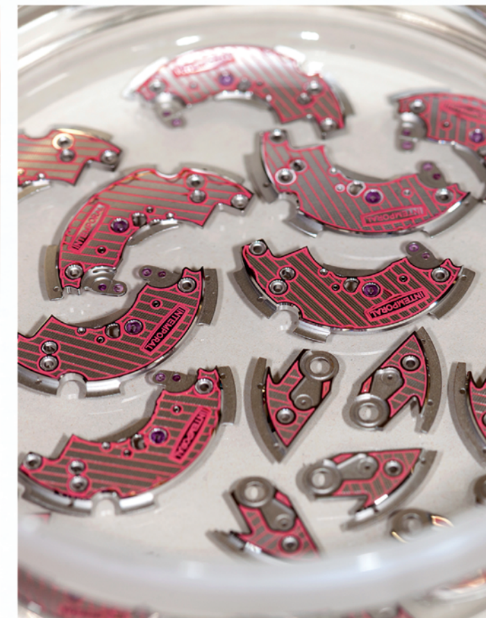
Rhodinieren: Im Anschluss an die Galvanik muss der Schutzlack von den Werkstücken vorsichtig entfernt werden.
