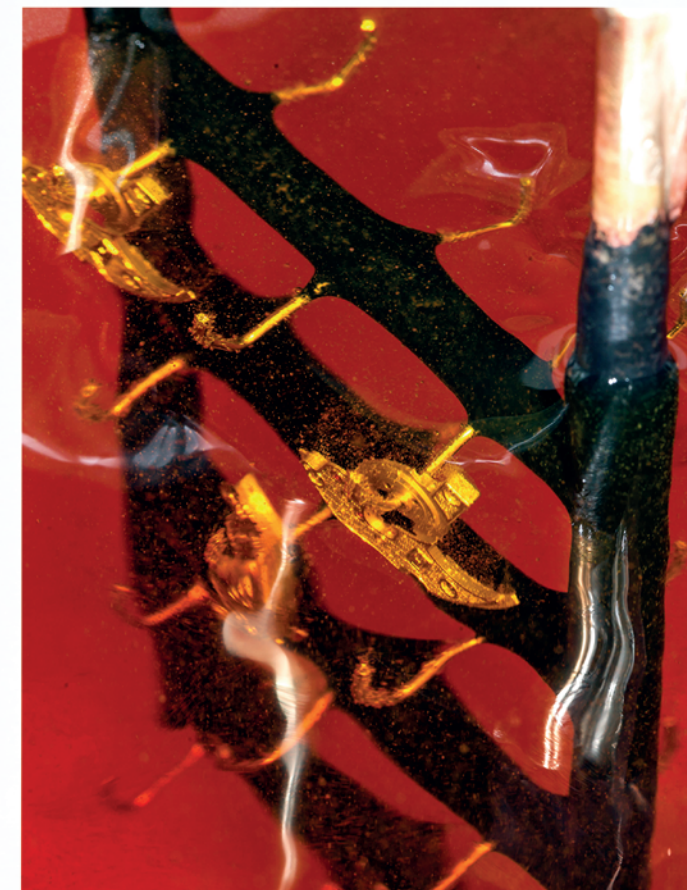
Galvanisieren von Hand: Mit Geduld und Sorgfalt nimmt ein Mitarbeiter bei Lehmann Schramberg die Galvanisierung vor.
