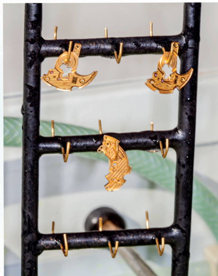
Vorbereitung: Die Werkstücke werden an einer leiterähnlichen Vorrichtung aufgehängt und in die galvanischen Bäder gegeben.
